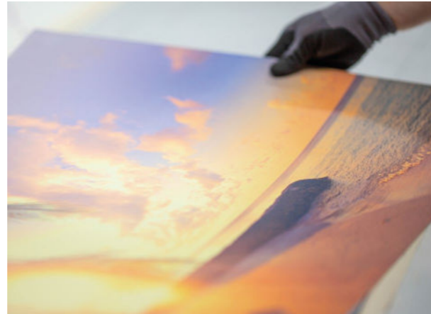
Druck eines persönlichen Fotomotivs auf eine Infrarotheizung mittels eines Cannon Flachbettdruckers.
